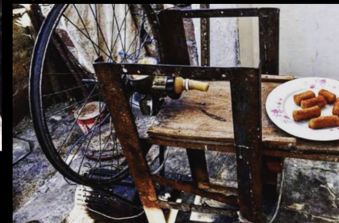
nestorsire Máquina de hacer croquetas. Motor eléctrico, llanta de bicicleta y máquina de moler carne. #cubacreativa
