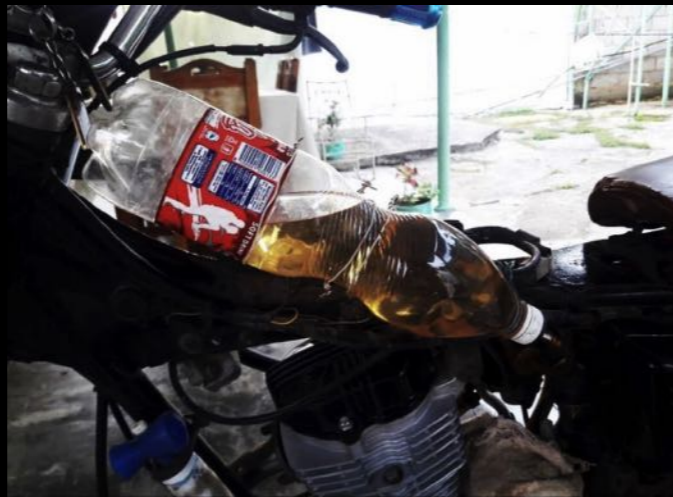
nestorsire Pomo plástico de soda adaptado como tanque de gasolina de motocicleta, válvula de bicicleta como reductor de líquido en la tapa del pomo. #cubacreativa
