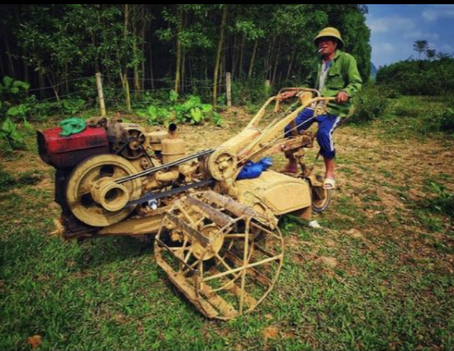
nestorsire Arado de arroz mecanico, construido con piezas de tractores y ruedas en forma de palas para mover sobre el lodo. #cubacreativa [VIETNAM] -
